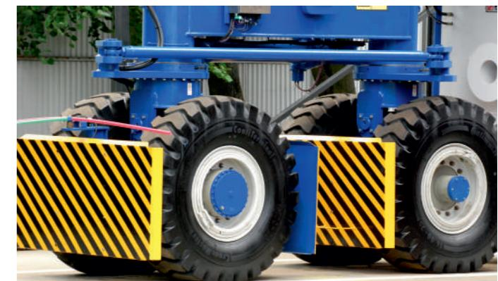
Специальная конструкция ходовой части обеспечивает оптимальное перемещение крана даже по неровной поверхности.
