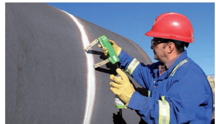
Неразрушающий контроль сварных швов и материалов
