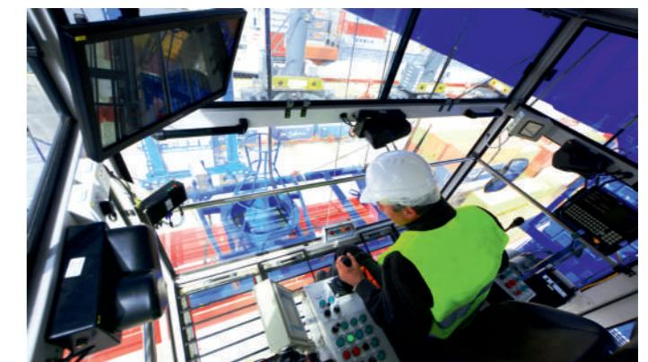
Просторная кабина с отличным круговым обзором, панель системы управления краном и видеомониторингом.
