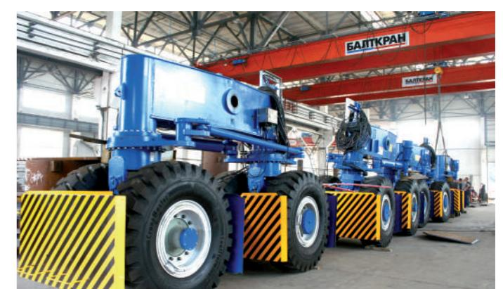
Механическая комплектация, сборка ходовых частей крана RTG
