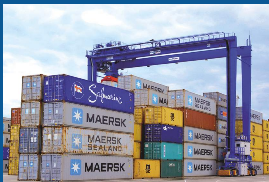
КРАН-ШТАБЕЛЁР НА РЕЗИНОВОМ ХОДУ ПОРТ БАЛТИЙСК, Г/П 41 Т
