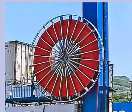
ЭЛЕКТРИЧЕСКИЙ КАБЕЛЬНЫЙ БАРАБАН ЕМКОСТЬЮ 250 МЕТРОВ.
