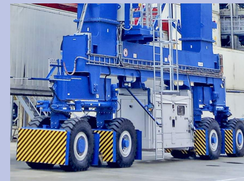
ХОДОВАЯ ЧАСТЬ АДАПТИРОВАНА К РАБОТЕ НА НЕРОВНЫХ ПОВЕРХНОСТЯХ.
